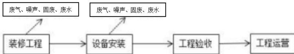
图 4 施工期工艺流程及排污节点图
